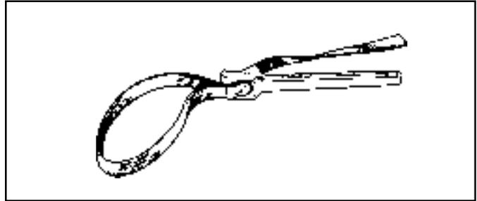
**HEAVY GAUGE WIRE HOOK FOR REMOVING MUFFLER SPRINGS**
